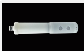
型号 : MAX-F-M5 尺寸 Size : \varnothing 44 \times 250 mm 流量 Flow : 1000-4000ml/min 压力 Pressure : 0.1-0.4MPa 前段 : 炭棒/PP棉 Front section : carbon rod, PP cotton
