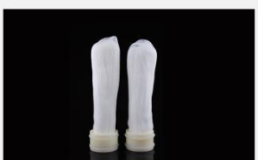
型号 : MAX-B-M16 尺寸 Size : \text{Ø}53 \times 200\text{mm} 流量 Flow : 2000-6000ml/min 工作压力 Working pressure : 0.1-0.4MPa 可用PS、PVDF膜丝 PS/PVDF fiber
