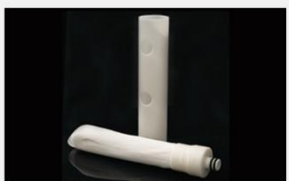
型号 : MAX-B-M27 尺寸 Size : \text{Ø}45 \times 235\text{mm} 流量 Flow : 2000-4000ml/min 工作压力 Working pressure : 0.1-0.4MPa 可用PS、PVDF膜丝 PS/PVDF fiber
