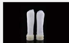
型号 : MAX-B-M18 尺寸 Size : \text{Ø}51 \times 200\text{mm} 流量 Flow : 2000-4000ml/min 工作压力 Working pressure : 0.1-0.4MPa 可用PS、PVDF膜丝 PS/PVDF fiber
