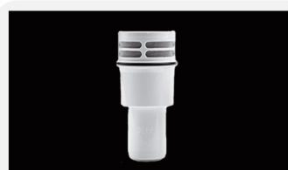
型号 : MAX-0.1-50 尺寸 Size : Ø57×119mm 组合 : 颗粒炭+超滤膜 Combination: particle carbon+UF 流量 Flow : 100-200ml/min 压力 : 无压自滴 Pressure: no pressure
