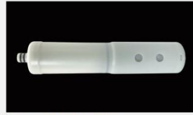
型号 : MAX-F-M6 尺寸 Size : Ø60×285mm 流量 Flow : 2000-6000ml/min 压力 Pressure :0.1-0.4MPa 前段 : 炭棒/PP棉 Front section : carbon rod, PP cotton
