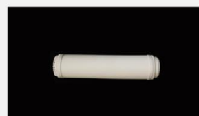
型号 : MAX-B-M30(10" ) 尺寸 Size : \text{Ø}65 \times 250\text{mm} 流量 Flow : 3000-10000ml/min 工作压力 Working pressure : 0.1-0.4MPa 可用PS、PVDF膜丝 PS/PVDF fiber
