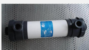
型号 : 4021 尺寸 Size : \varnothing 90 \times 500 mm 接口 Connector : \varnothing 32 , DN25 流量 Flow : 480L/h 工作压力 Working pressure : 0.1-0.4MPa
