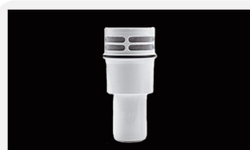
型号 : MAX-0.1-50 尺寸 Size : Ø57×119mm 组合 : 颗粒炭+超滤膜 Combination: particle carbon+UF 流量 Flow : 100-200ml/min 压力 : 无压自滴 Pressure: no pressure
