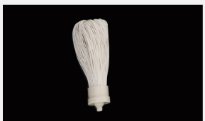
型号 : MAX-B-M35 尺寸 Size : \text{Ø}45 \times 200\text{mm} 流量 Flow : 2000-5000ml/min 工作压力 Working pressure : 0.1-0.4MPa 可用PS、PVDF膜丝 PS/PVDF fiber 1/4" 螺纹 thread
