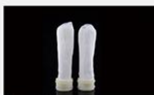
型号 : MAX-B-M18 尺寸 Size : Ø51×200mm 流量 Flow : 2000-4000ml/min 工作压力 Working pressure : 0.1-0.4MPa 可用PS、PVDF膜丝 PS/PVDF fiber
